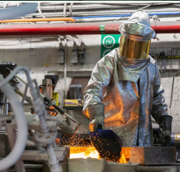
En haut : Des échantillons d'or affiné en plein essai pyrognostique.
